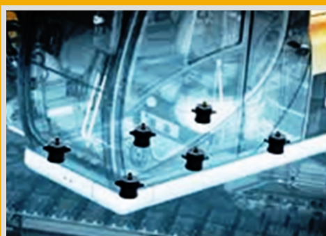
駕駛室避震系統，可減少操作時的晃動，大幅提升舒適度，減少駕駛員的疲勞，提升工作效率
